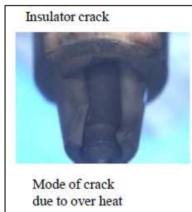
Obr. 6 (prasknutí izolátoru, prasknutí kvůli přehřátí)
