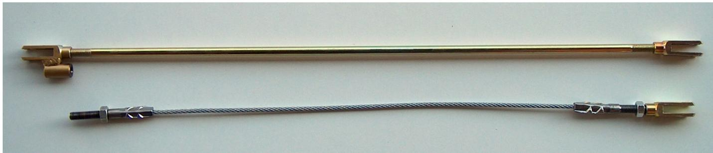
**La commande de freinage doit être isolée du châssis et montrer la double commande**
