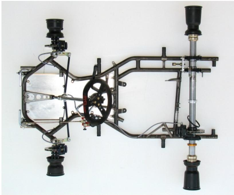
PHOTO VUE DE DESSUS DU CHÂSSIS COMPLET IDENTIQUE À L'UN DES MODÈLES PRÉSENTÉS À L'HOMOLOGATION SANS PARE-CHOCS, CARROSSERIE, SIEGE, NI PNEUMATIQUES
